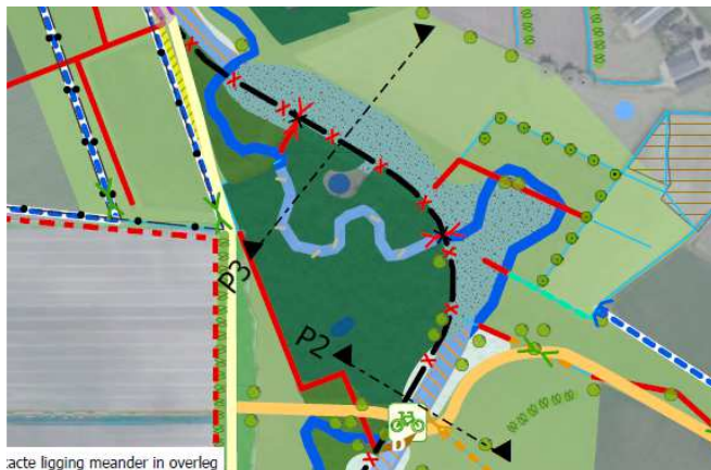
Figuur 4.1: Variant van het principeprofiel 'meander + hoogwatergeul' in het projectgebied, waarbij de hoogwatergeul als moeras gaat functioneren.
